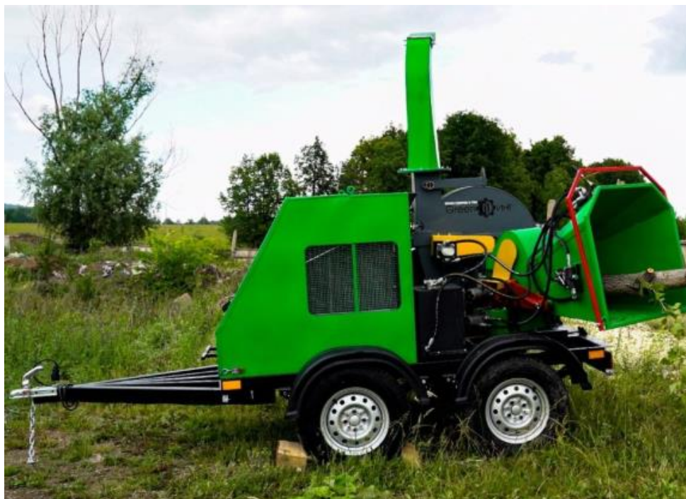
Рис. 7. Мобильная рубительная машина GreenПинг WC750 на прицепе
