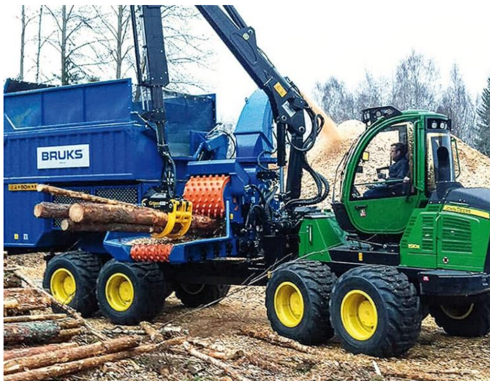
Рис. 8. Самоходная рубительная машина, на базе форвардера
