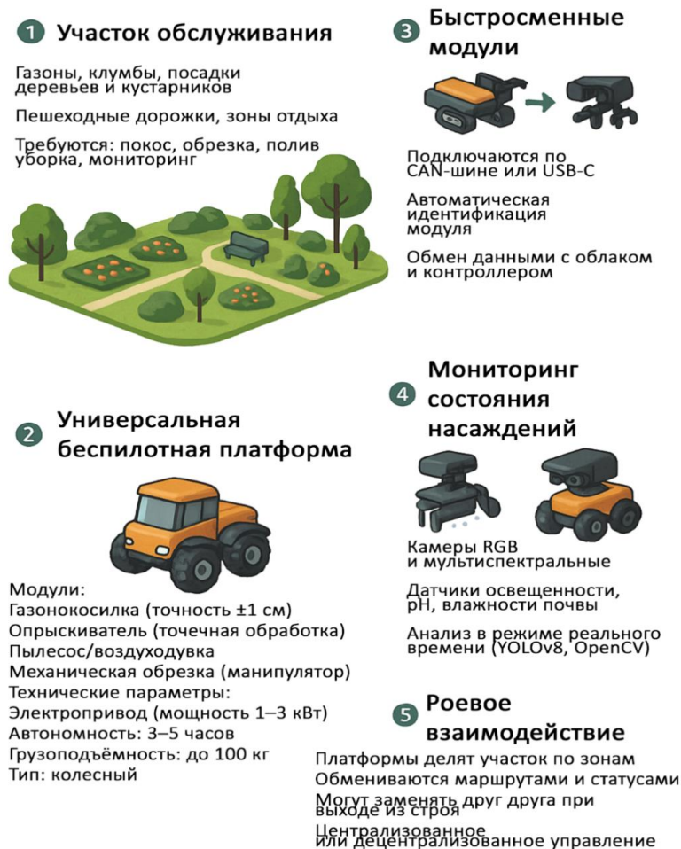
Рис. 4. Схема работы беспилотной платформы в садово-парковом хозяйстве
