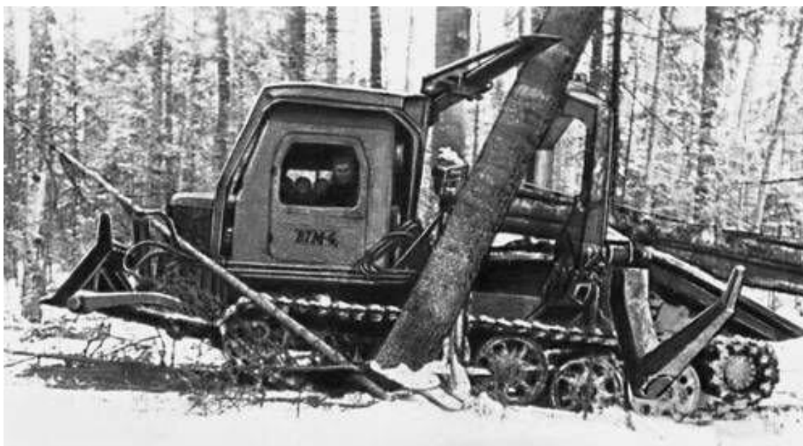
Рис. 1. Узкозахватная фланговая гусеничная валочно-трелевочная машина ВМ-4А
