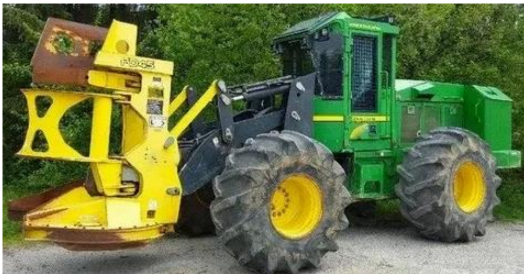
Рис. 6. Колесная узкозахватная фронтальная лесозаготовительная машина John Deere 843J (фото)
