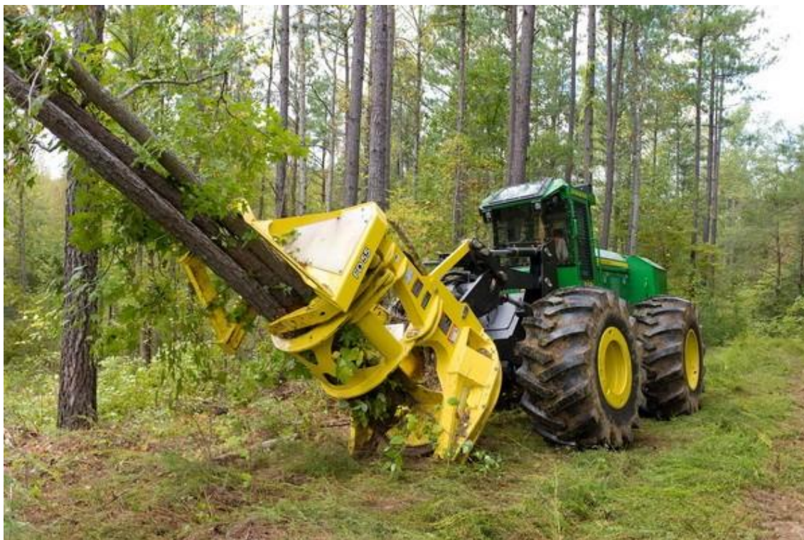
Рис. 10. Колесная узкозахватная фронтальная лесозаготовительная машина John Deere 843J с ЗСУ с накопителем
