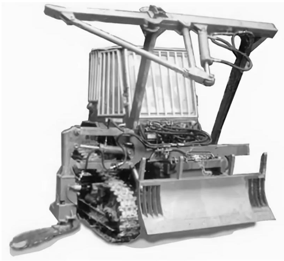
Рис. 2. Узкозахватная фланговая гусеничная валочная машина ВМ-55
