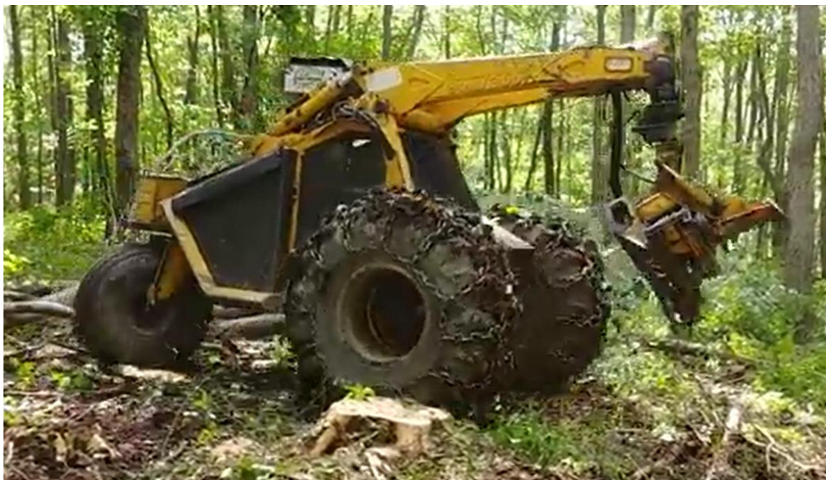
Рис. 8. Колесная (трицикл) узкозахватная фронтальная лесозаготовительная машина Bell
