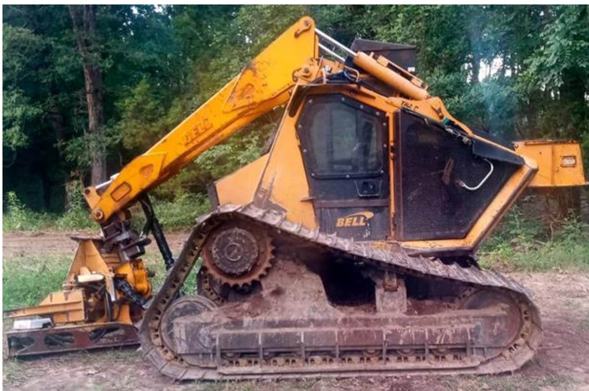
Рис. 9. Гусеничная узкозахватная фронтальная лесозаготовительная машина Bell
