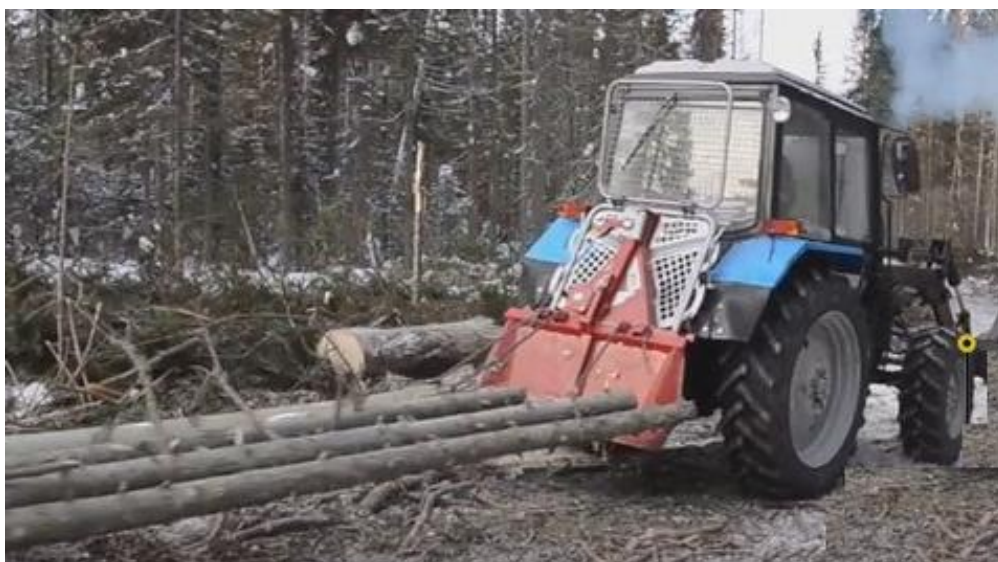
Рис. 13. Трелевочный трактор МТЗ на трелевке хлыстов полупогруженном положении, оснащенный чокерным захватом «Горыныч»
