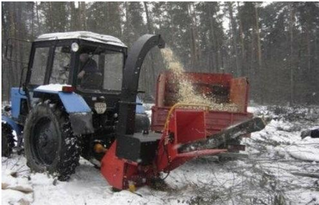
Рис.17. Мобильная рубительная машина с приводом от ВОМ трактора МТЗ
