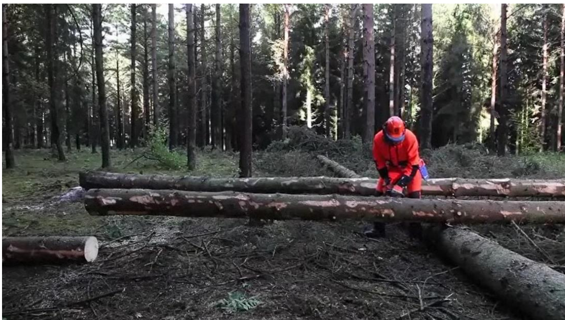
Рис.12. Раскряжевка бензиномоторной пилой на верхнем складе
