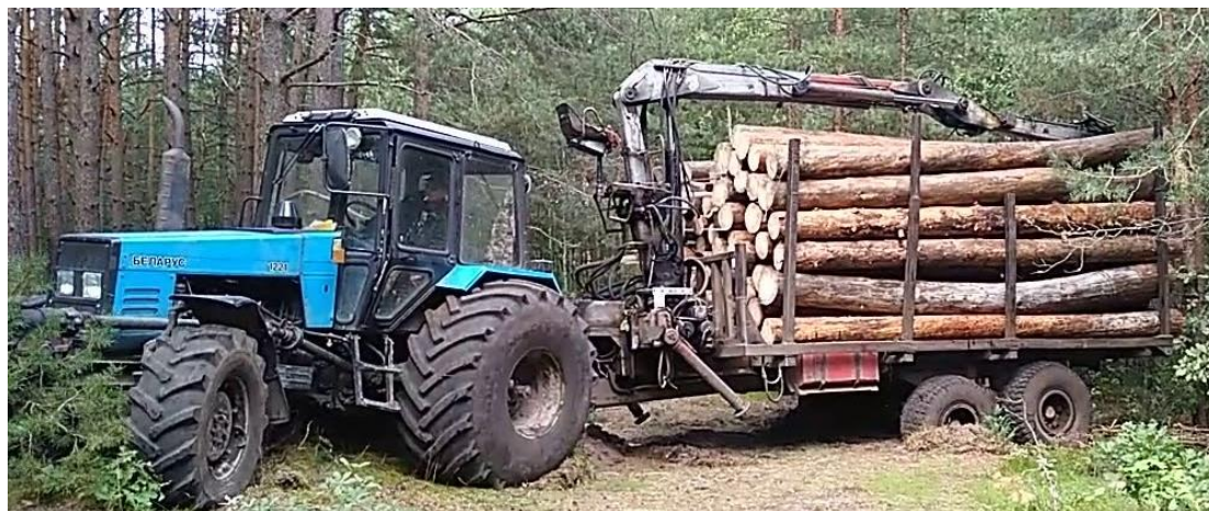
Рис.15. Форвардер на базе трактора МТЗ
