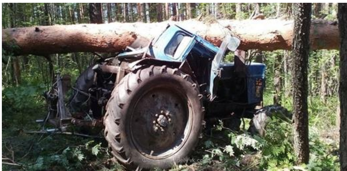
Рис.18. Последствия падения дерева на кабину трактора МТЗ
