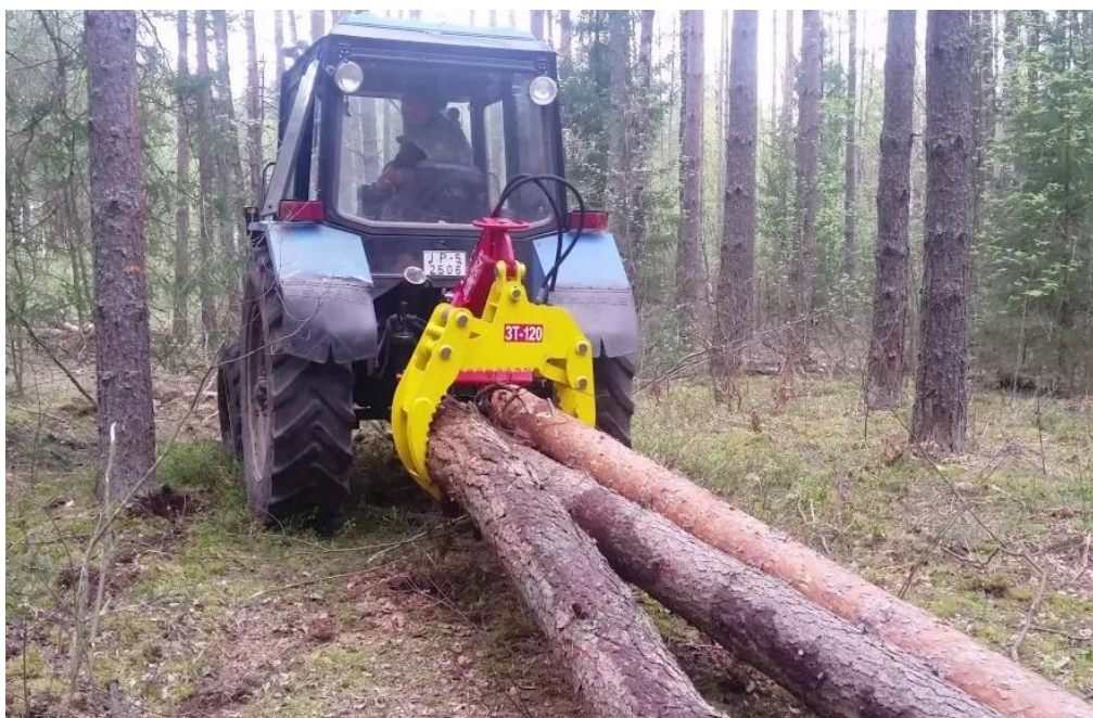
Рис.14. Трелевочный трактор МТЗ на трелевке хлыстов полуподвешенном положении, оснащенный грейферным захватом
