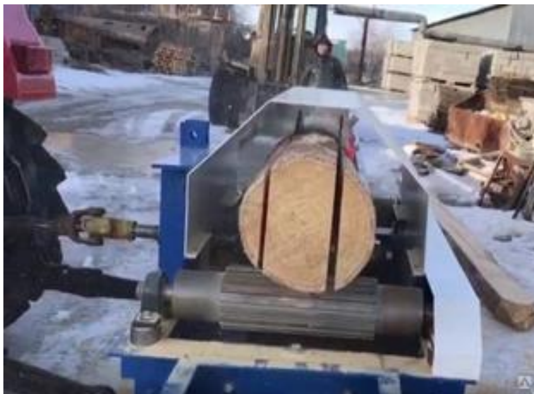
Рис.16. Мобильный лесопильный станок с приводом от ВОМ трактора МТЗ
