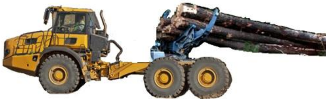
Рис. 24. Концепт бесчокерного трелевочного трактора на базе шасси самосвала Bell B25E (производства ЮАР) без гидроманипулятора
