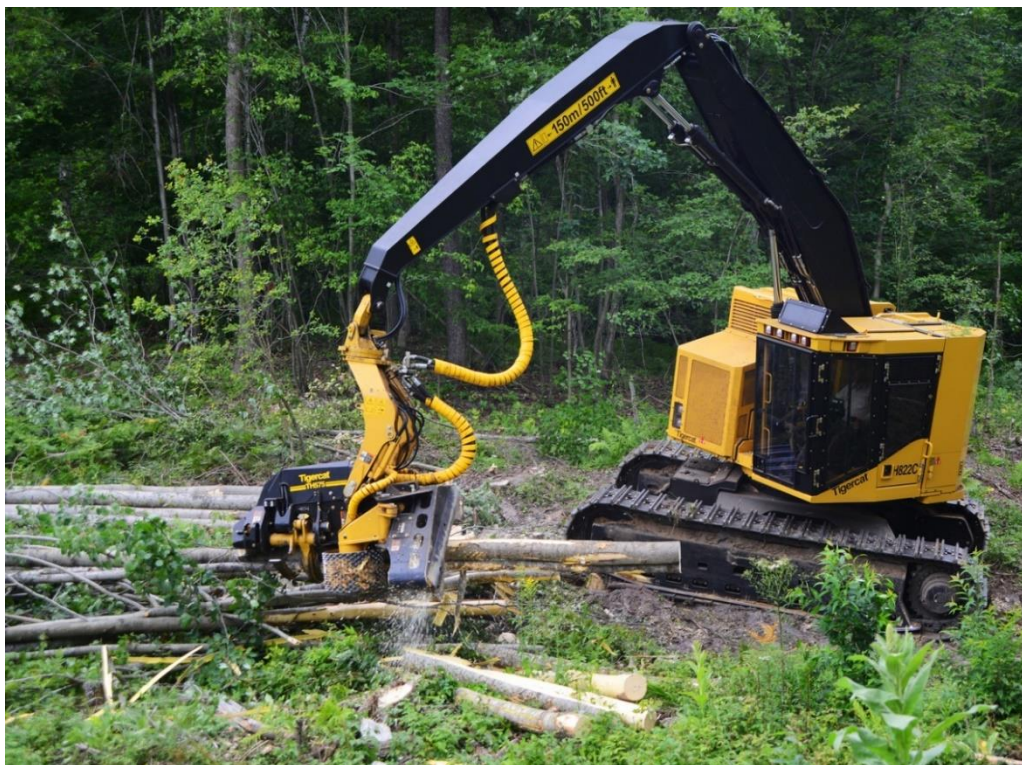
Рис.13. Гусеничный харвестер на экскаваторной базе
