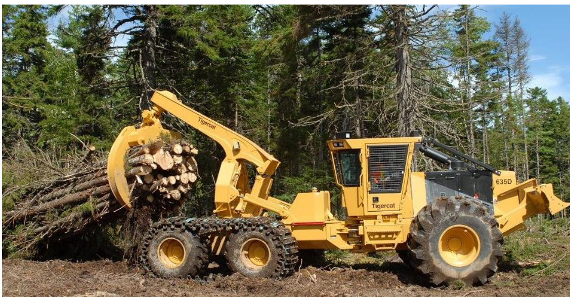
Рис. 9. Трактор с пачковым захватом (пачкоподборщик, скиддер)
