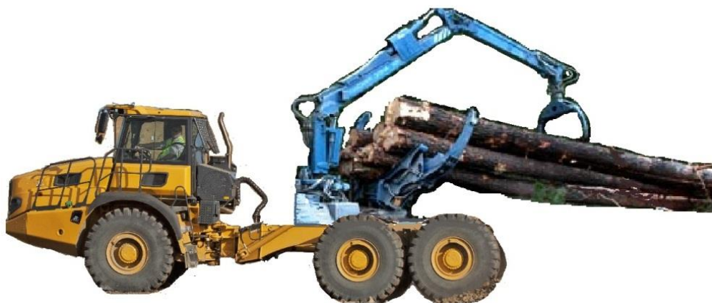
Рис. 17. Концепт бесчокерного трелевочного трактора на базе шасси самосвала Bell B25E (производства ЮАР)
