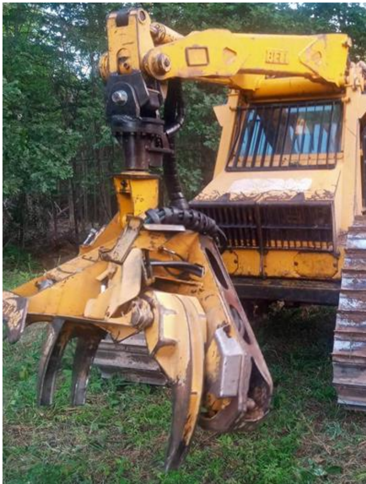
Рис. 21. Валочная машина Bell, вид спереди на захватно-срезающее устройство (ЗСУ)
