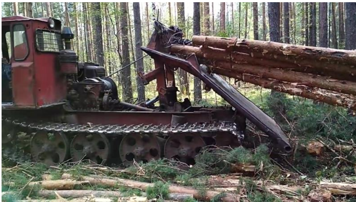
Рис. 5. Затаскивание собранной пачки на щит чокерного трелевочного трактора
