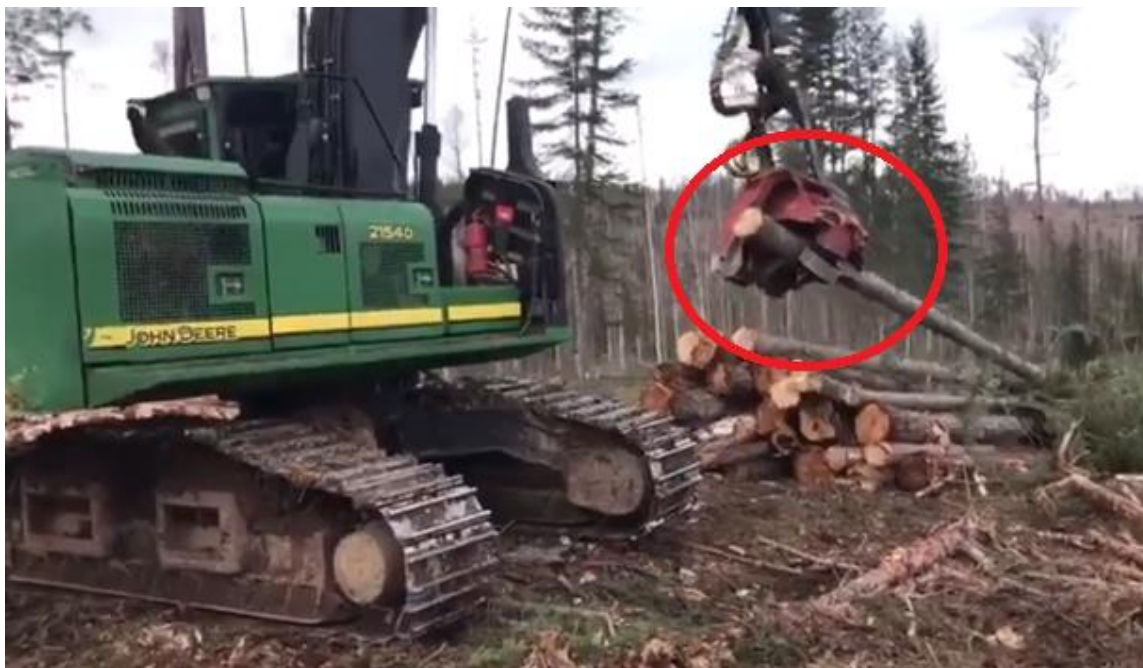
Рис. 27. Вальцовый процессорный агрегат на гусеничном экскаваторе
