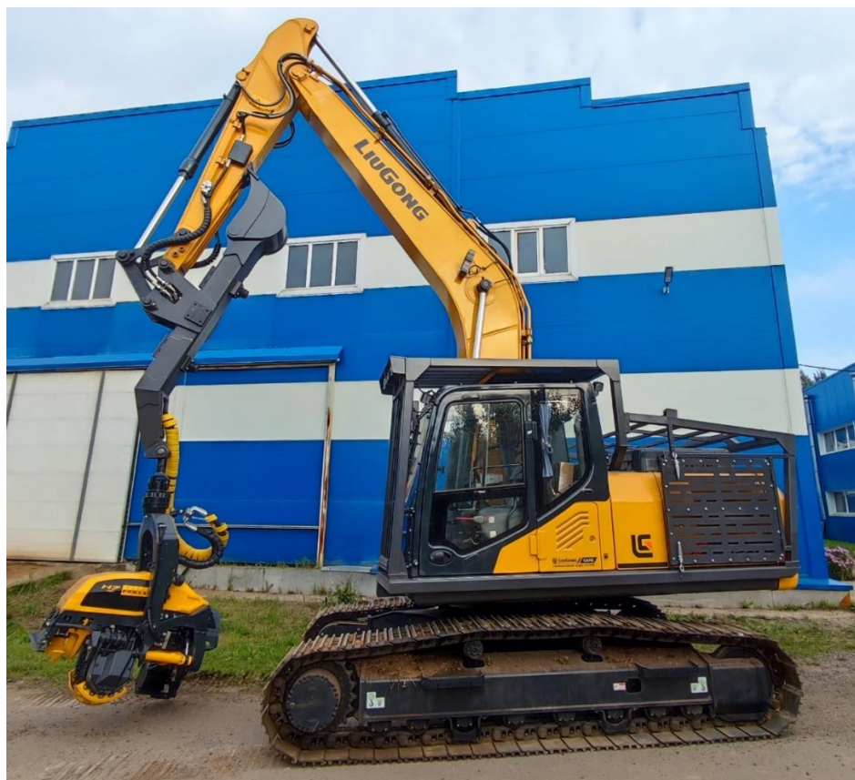
Рис. 14. Переоборудованный в харвестер экскаватор LiuGong
