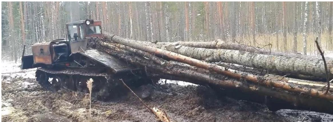
Рис. 2. Трелевка хлыстов чокерным трактором в полупогруженном положении
