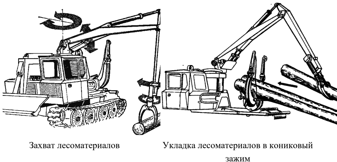
Рис. 8. Приемы работы бесчокерного трелевочного трактора при наборе пачки на технологической стоянке
