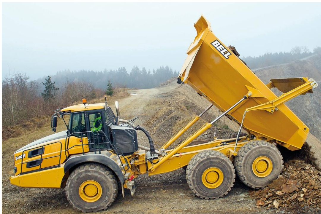
Рис. 19. Шарнирно-сочлененный карьерный самосвал (основная продукция машиностроительной компании Bell (ЮАР))
