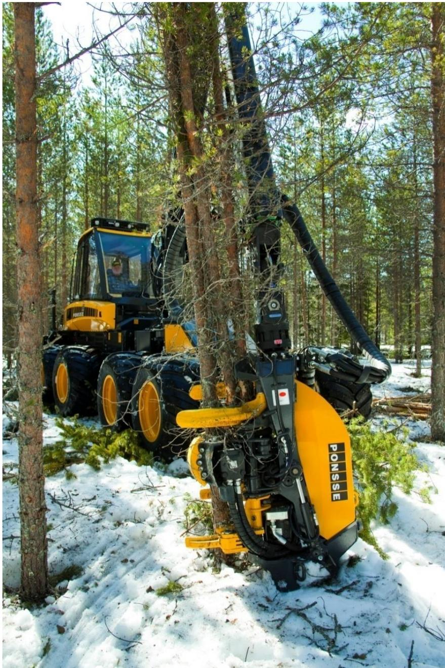
**Рис.12.** Харвестерная головка с накопителем
