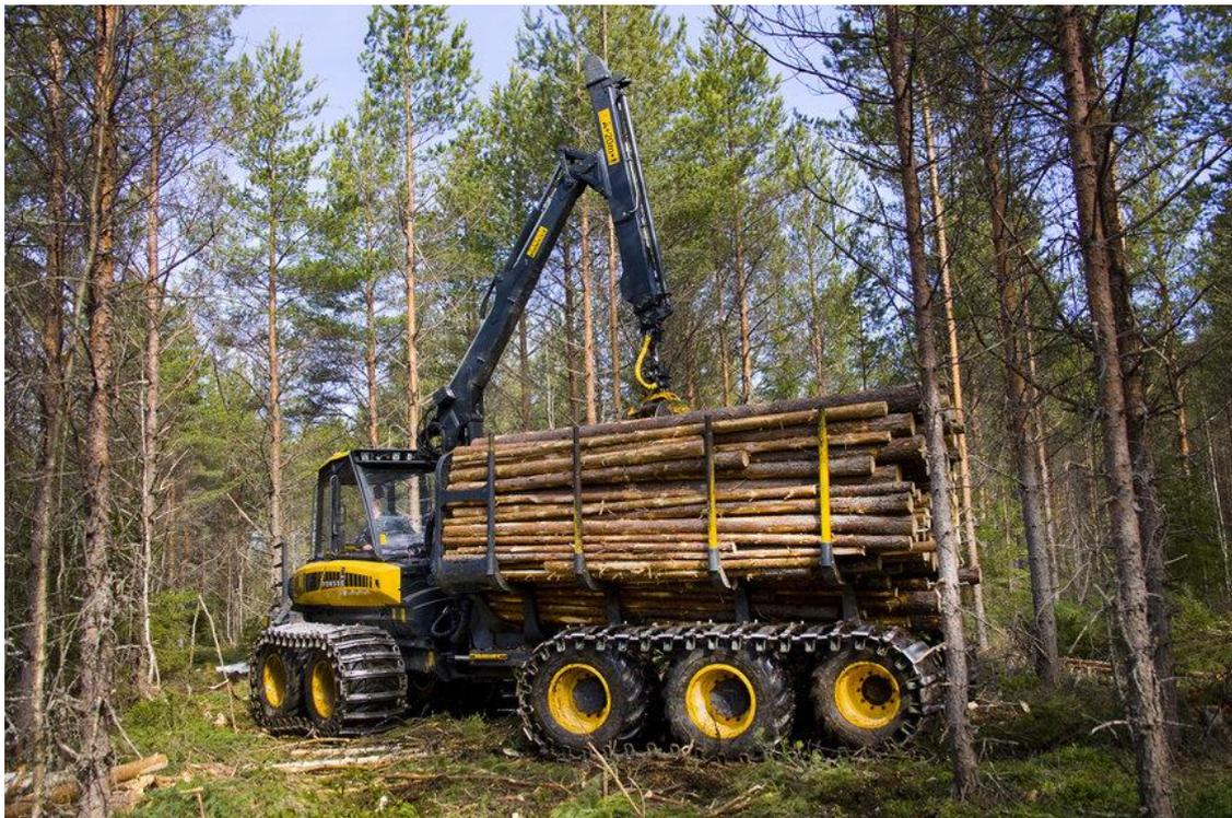
Рис. 13. Форвардер оснащенный колесными гусеницами
