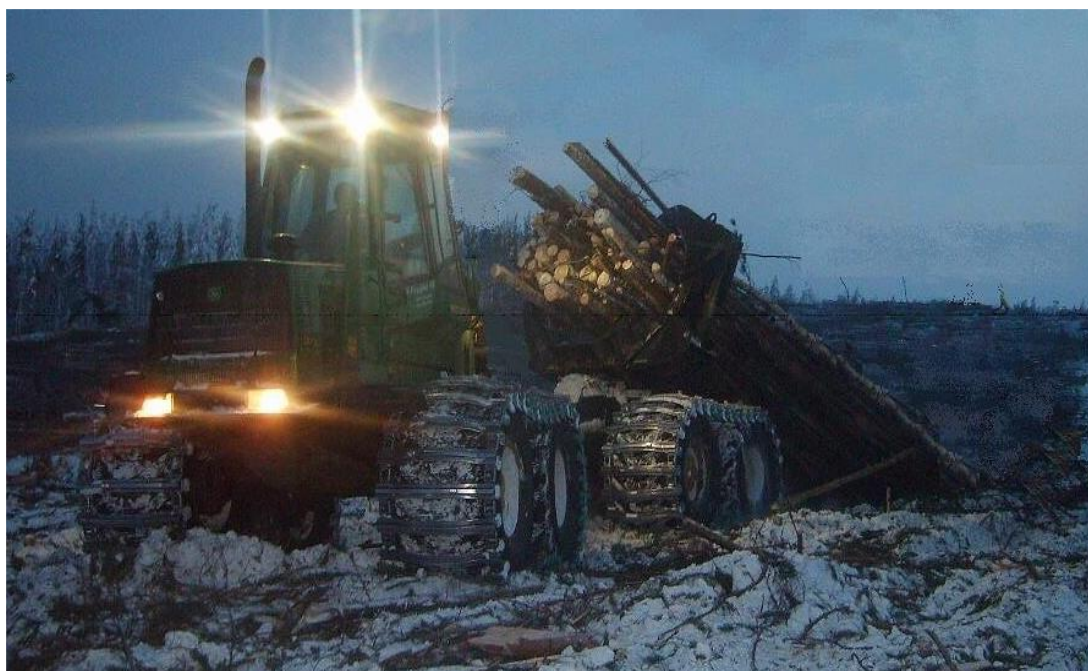
Рис. 9. Трелевка пачки древесины бесчokerным трактором без гидроманипулятора
