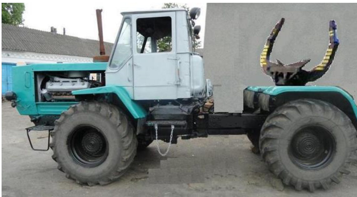
Рис. 8. Сельскохозяйственный колесный трактор ОрТ3-150К, с кониковым зажимным устройством (фотомонтаж)
