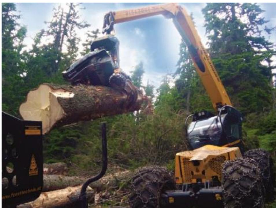
**Рис.4.** Поштучная погрузка круглых лесоматериалов ВТИМ HIGHLANDER
