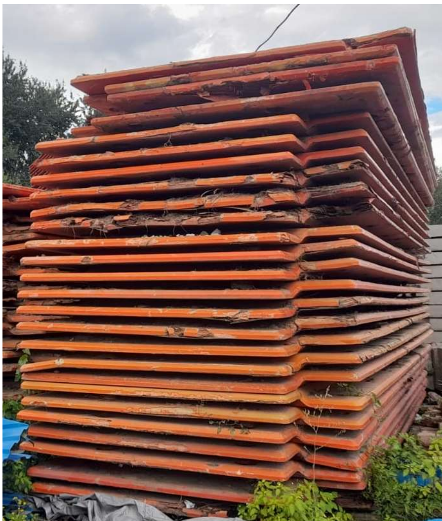
Рис.7. Дорожные пластиковые маты с локальными разрушениями конструкции
