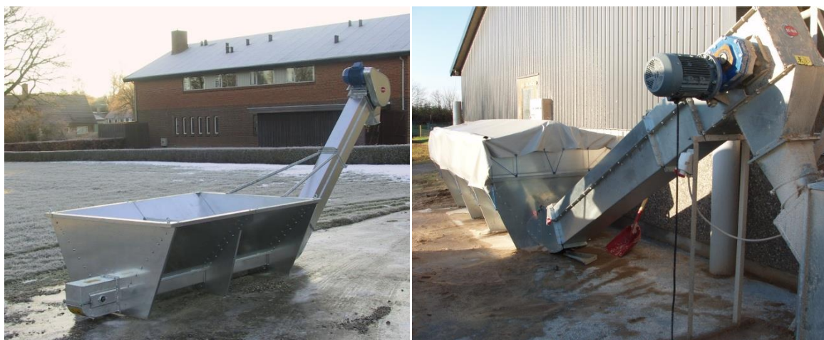
Фото 4. Завальные ямы надземного исполнения: а – общий вид без надстроечных бортов; б – яма в рабочем положении, рядом с зернохранилищем фирма «Jema» (Дания).
