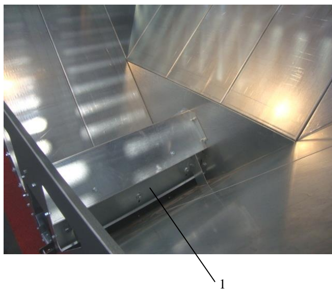
Фото 7. Фрагмент завальной ямы модульного исполнения с скребково-цепным транспортером: 1 – регулируемые пластины, установленные вдоль нижней ветви скребково-цепного транспортера.
