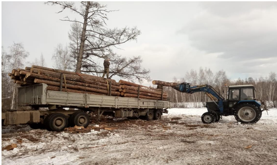
Рис. 5. Колесный сельскохозяйственный трактор, оснащенный технологическим оборудованием для погрузки круглых лесоматериалов на лесовозный транспорт, Республика Саха (Якутия), 2023 г.
