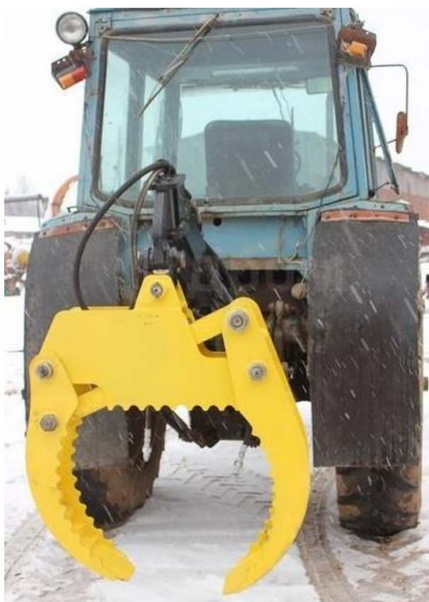
Рис. 3. Колесный сельскохозяйственный трактор, оснащенный грейферным захватом
