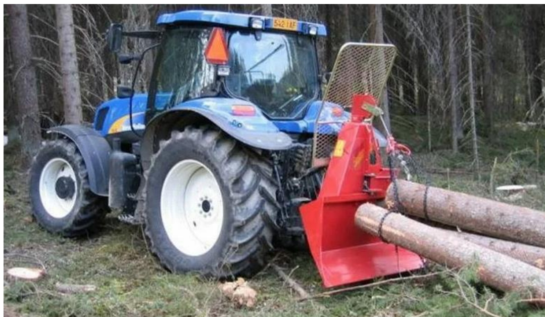
Рис. 1. Колесный сельскохозяйственный трактор, оснащенный технологическим оборудованием для чокерной трелевки
