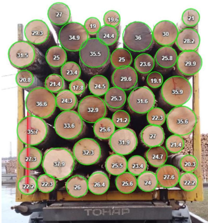
Рис. 5. Определение диаметров торцов партии
