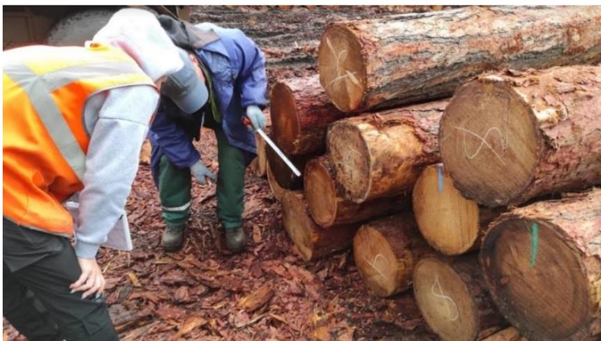
**Рис. 3.** Измерения пиловочника хвойного на складе сырья вручную по таблицам ГОСТ 2708-1975
