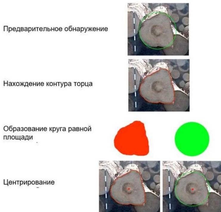
**Рис. 6.** Этапы распознавания торцов брёвен машинным зрением программы Timbeter
