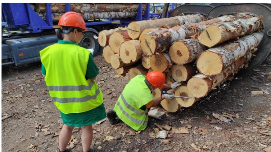
Рис. 1. Измерения фанерного кряжа на складе сырья вручную [5]
