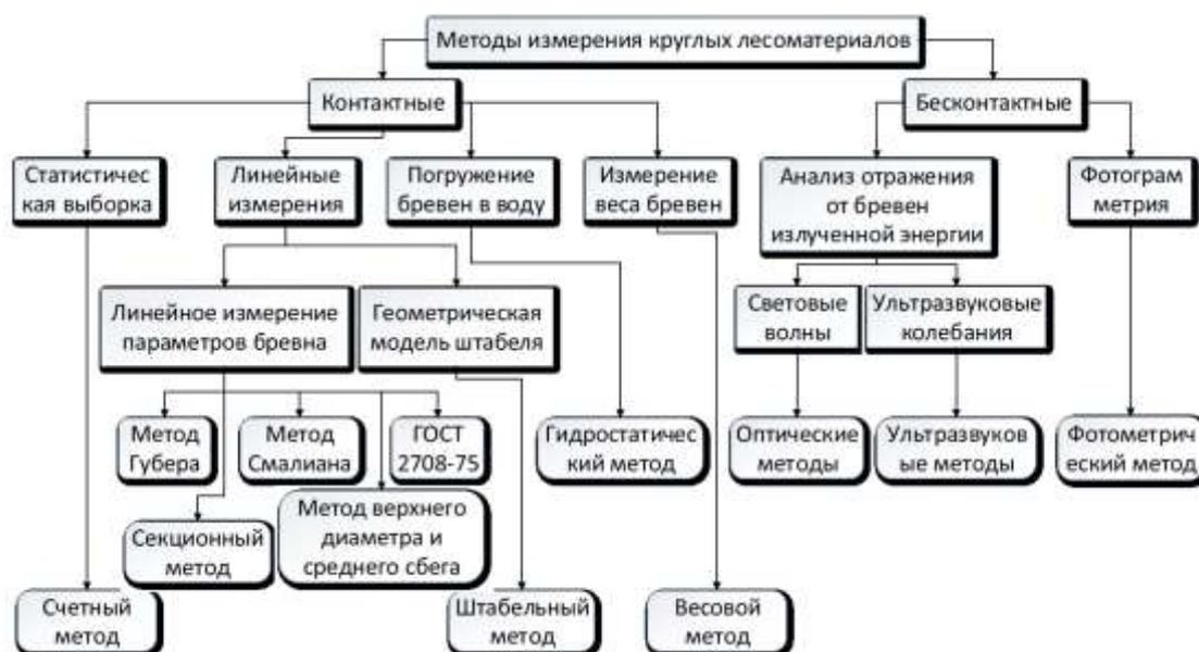
**Рис. 8.** Классификация методов измерения объема круглых лесоматериалов по способу взаимодействия с объектом в процессе измерения
