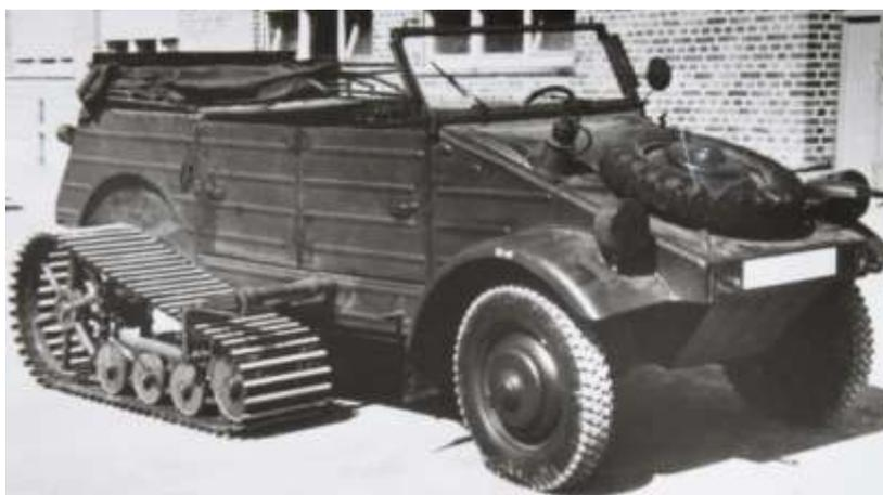
**Рис. 2.** Полугусеничный ход автомобильной базы
