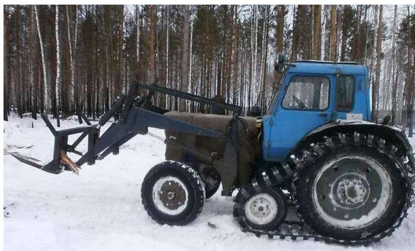
**Рис. 3.** Полугусеничный ход тракторной базы
