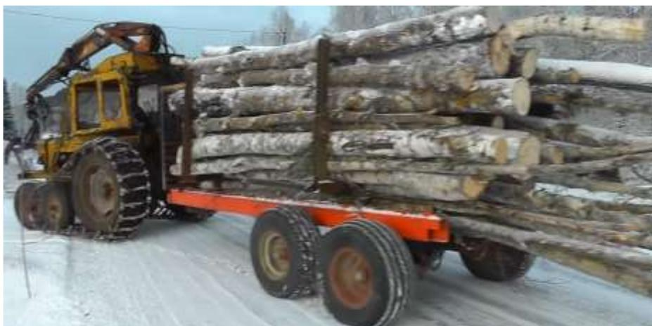
**Рис. 4.** Форвардер на базе трактора на полугусеничном ходу
