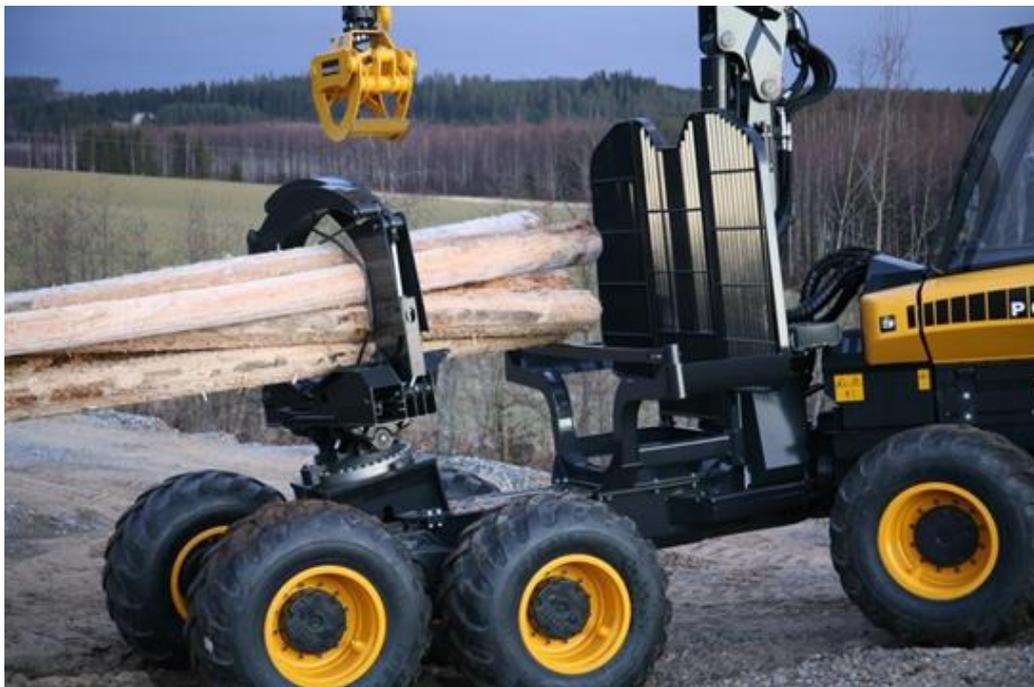
**Рис. 1.** Бесчокерный трактор на форвардерной базе
